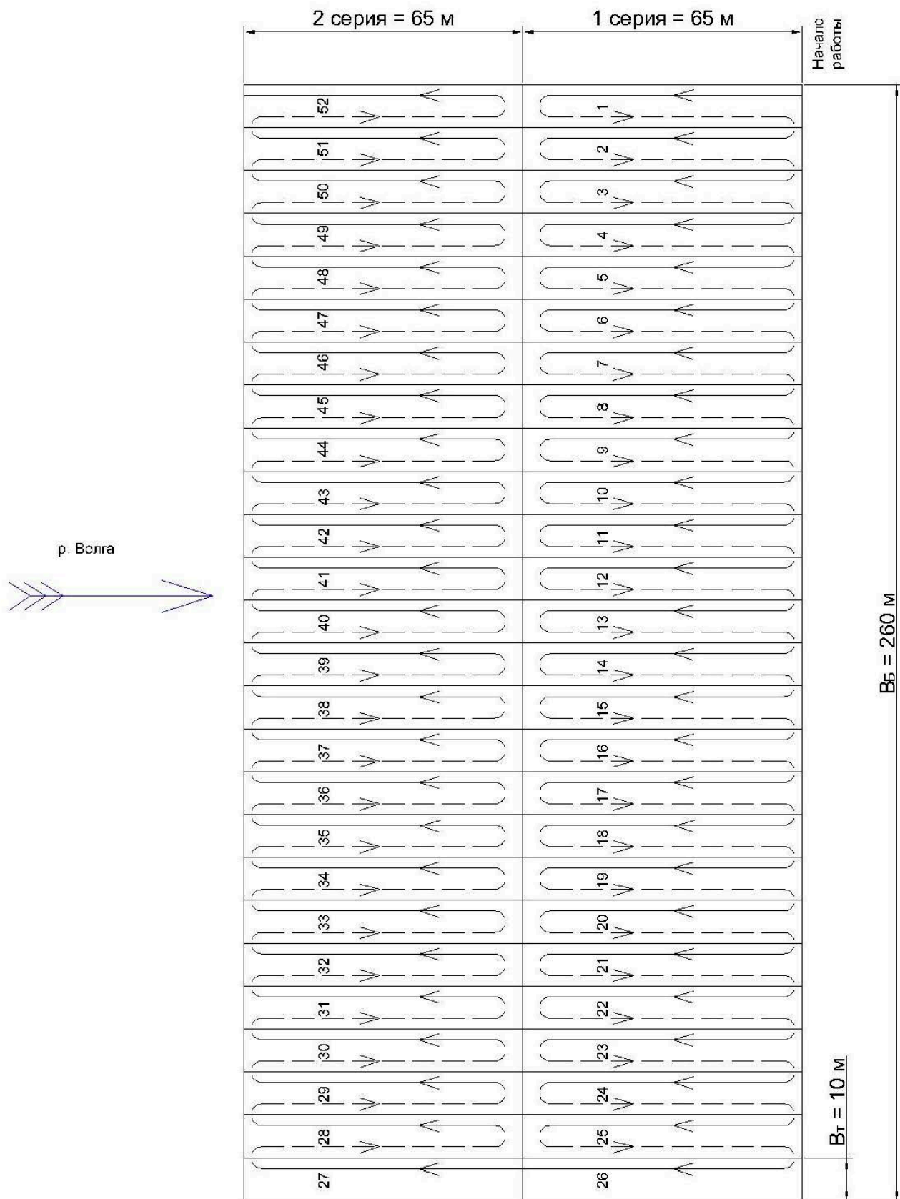
Рисунок 6.2 – Схема рабочих перемещений землесосного снаряда траншеями, сериями против течения
