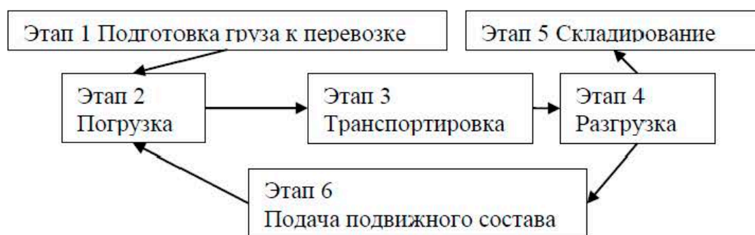
Рисунок 1 - Технологическая схема перевозки грузов одним транспортом [11].
