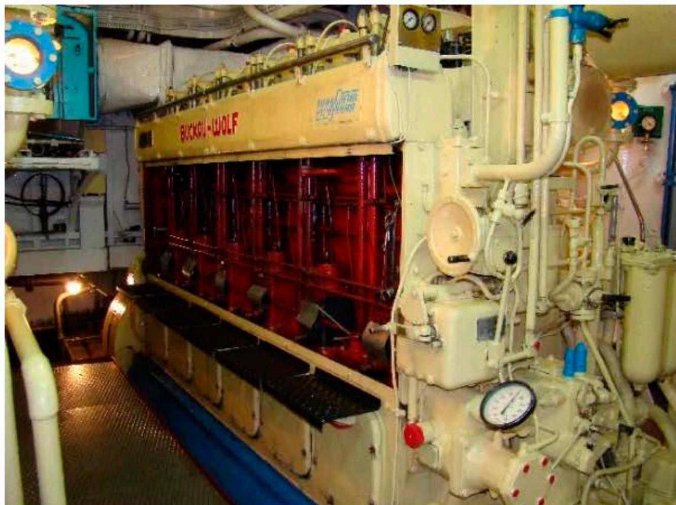
Рисунок 1.2 - Главный двигатель 6NVD48U
