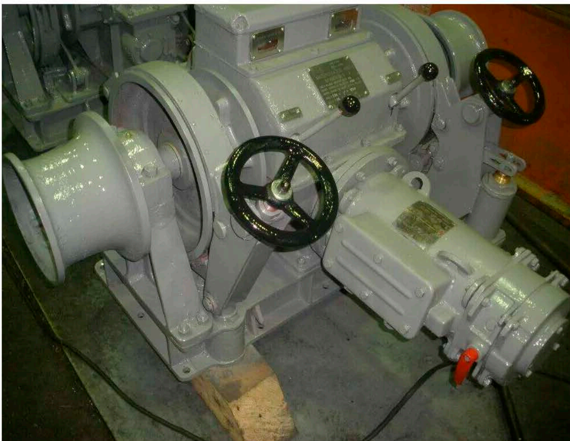
Рисунок 3 – Общий вид брашпиля Б-1Р.
