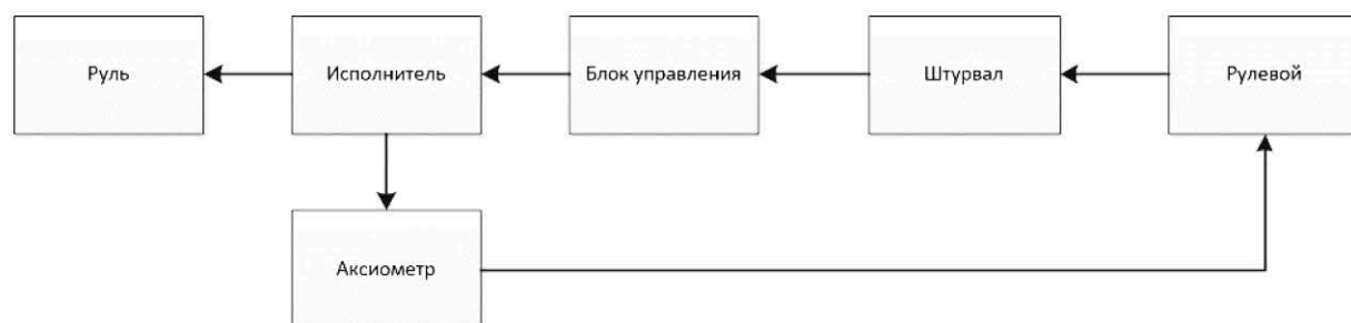
Рисунок 1.3 - Структурная схема ручного управления курсом судна
