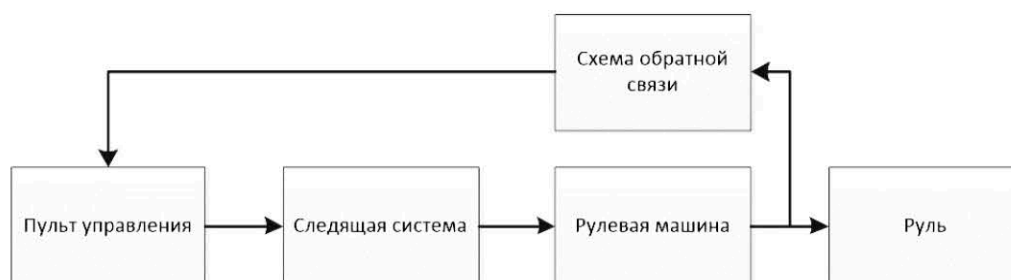
Рисунок 1.4 - Структурная схема следящего управления курсом судна [3]
