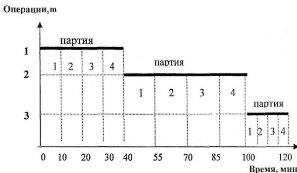
Рис. 3.1. График последовательного способа организации технологического процесса во времени
