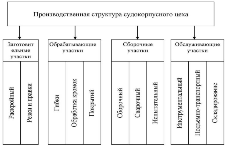
Рис. 4.3. Производственная структура судокорпусного цеха
